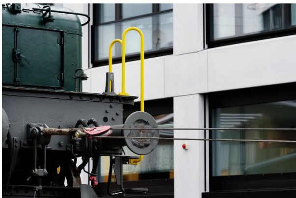
Hinten schiebt die Diesellokomotive, vorne zieht der Drahtseilzug des Lastwagens das Krokodil auf den Tieflader.
