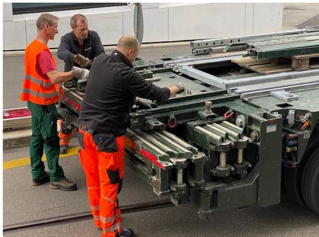
Die Schienen fürs Hochziehen sind eingeklapptes Teil des Tiefladers
